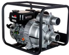
La bomba de basura autocebante Toyota TOTWP80T-XP, fue desarrollada para uso profesional. Está equipado con un motor de gasolina de máxima potencia de 7 hp con arranque manual. Fabricado con materiales de alta resistencia y durabilidad, tiene un cuerpo de aluminio con un diámetro de succión de 3" y un diámetro de descarga de 3". El rotor y la voluta están fabricados en hierro fundido. Dispone de un marco tubular que protege el conjunto y facilita el transporte.
