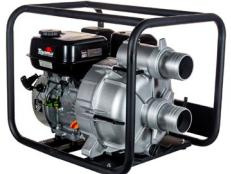
La bomba de basura autocebante Toyama TWP80T-XP,fue desarrollada para uso profesional. Está equipado con un motor de gasolina de máxima potencia de 7 hp con arranque manual. Fabricado con materiales de alta resistencia y durabilidad, tiene un cuerpo de aluminio con un diámetro de succión de 3" y un diámetro de descarga de 3". El rotor y la voluta están fabricados en hierro fundido. Dispone de un marco tubular que protege el conjunto y facilita el transporte.
